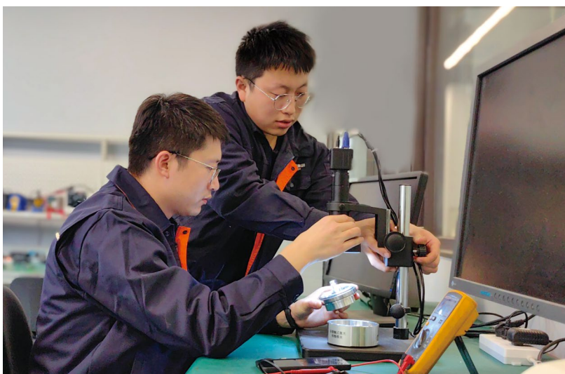
技术人员对在研的非接触式激光滑环核心模块测试验证
